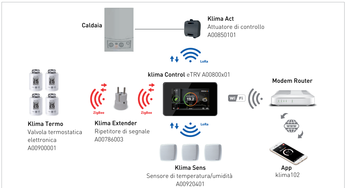
Schema di impianto Klima102 con valvole termostatiche wireless (eTRV)
